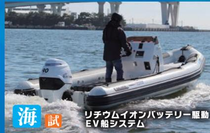
リチウムイオンバッテリー駆動 EV船システム
